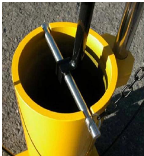
20-килограммовый молот, поддерживаемый опорным штифтом во время транспортировки
