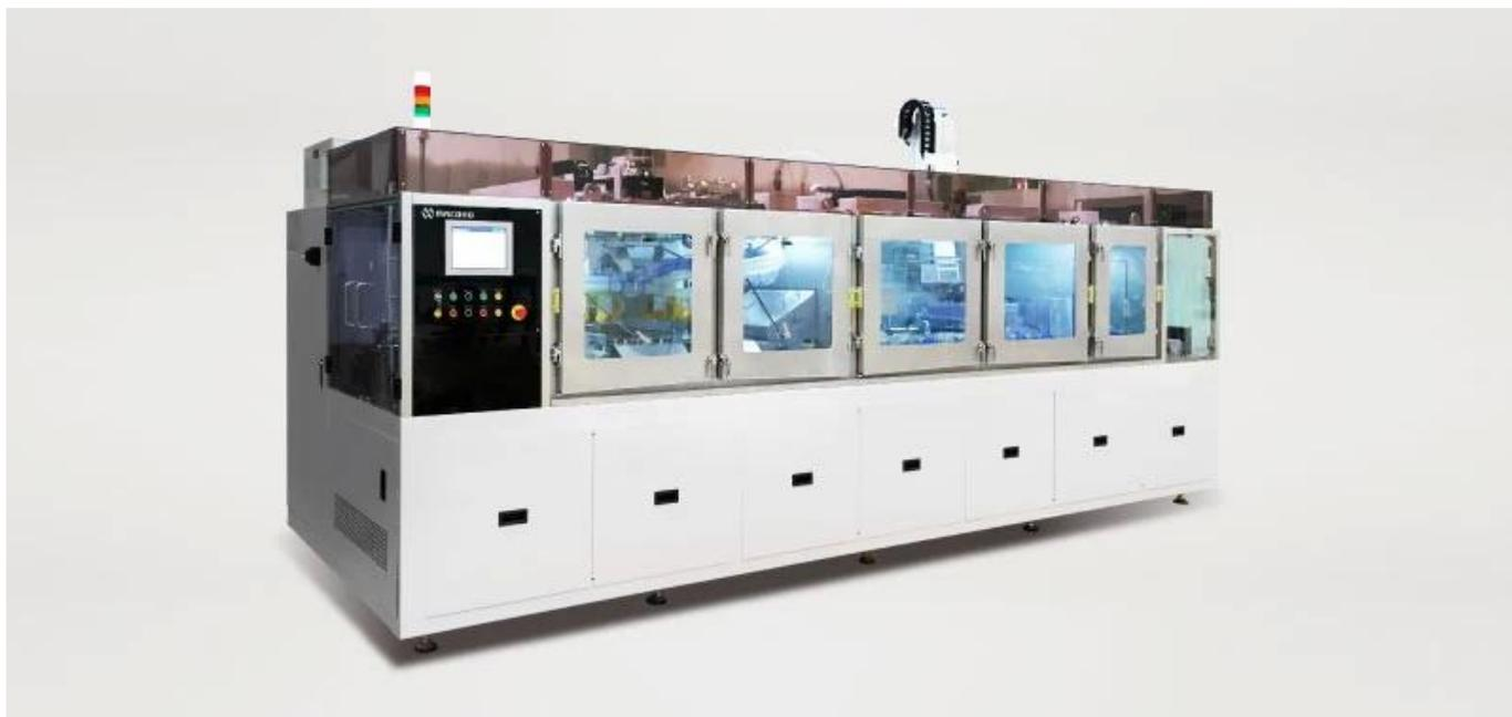
L'elaborazione completamente automatica dalla sabbiatura alla pulizia e all'asciugatura può essere eseguita con un'unità.
