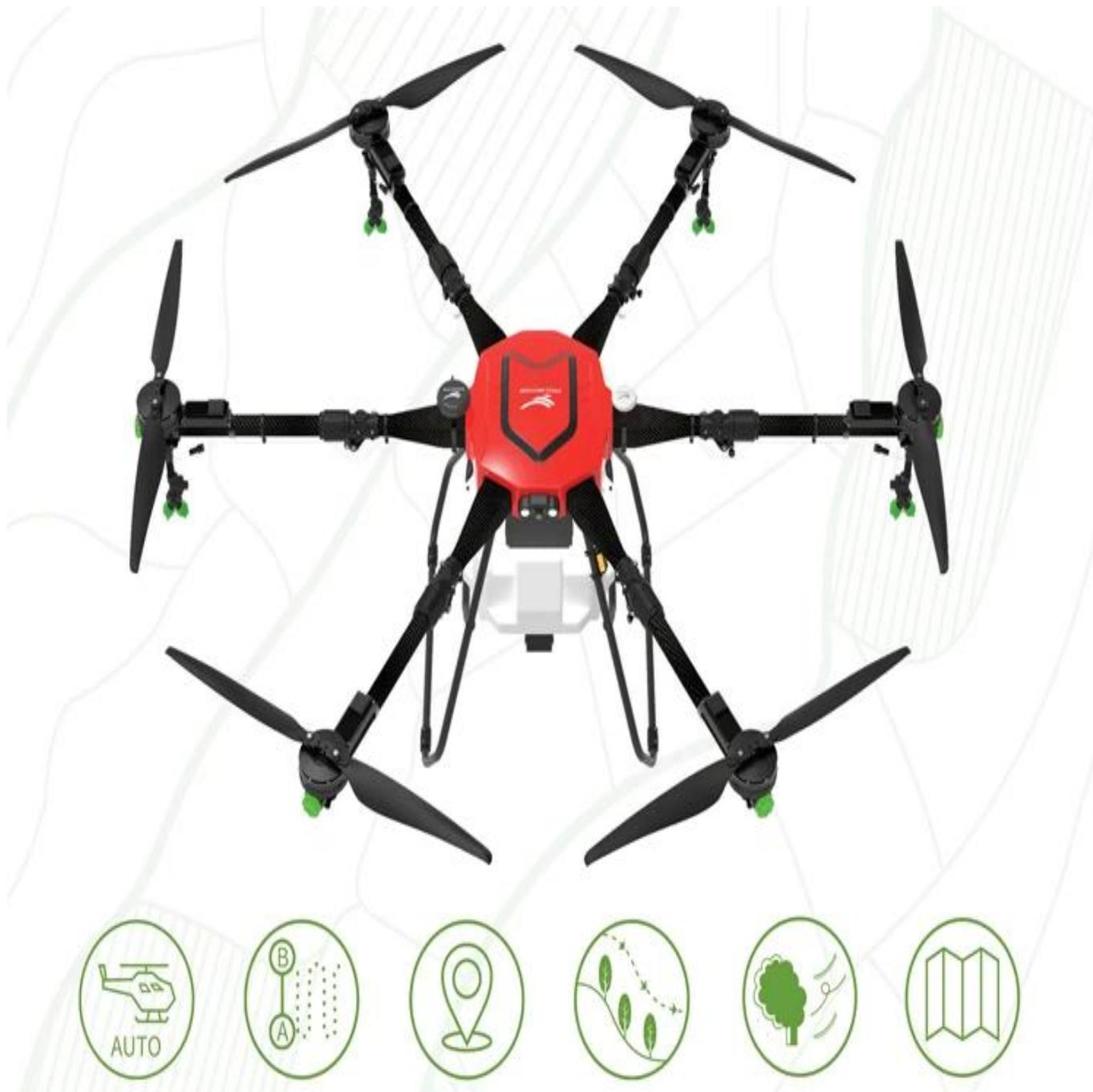
X25 è una macchina per la protezione delle piante elettrica a Sei assi, con un design della struttura semplice, un'elevata efficienza operativa, un controllo semplice e ha funzioni come l'imitazione del volo a terra e l'evitamento autonomo degli ostacoli. La sua scena è ampiamente applicabile e può essere applicata a vari ambienti e terreni, come terraferma, colline, montagne, ecc.
