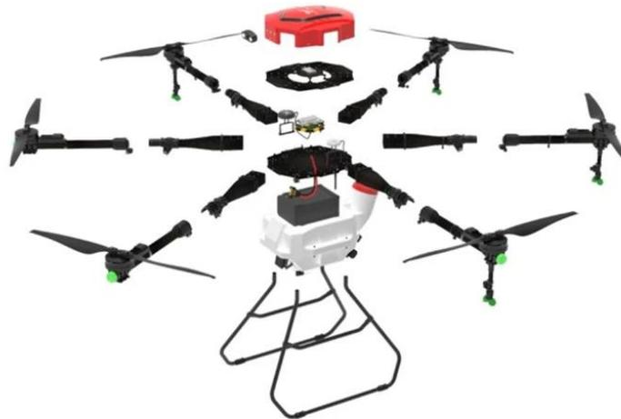
Dotato di 4 teste di irrigazione gemelle
