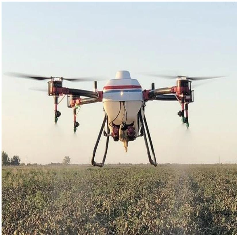
Il carico standard del design M12 è di 12 kg e il carico elevato può raggiungere i 13,6 kg. Rispetto al carico generale di 10 kg sul mercato, può far funzionare 10 mu in più di terra in un'ora, asciugare 60 mu in più in un giorno e migliorare l'efficienza operativa di oltre il 20%.
