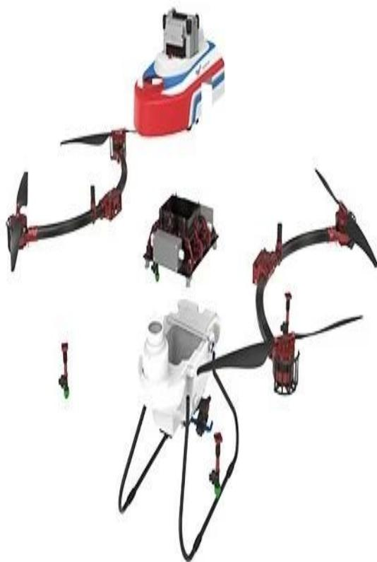
La macchina completa M12 è suddivisa principalmente in 7 moduli: batteria di alimentazione, cofano, telaio della fusoliera, serbatoio del liquido liquido, treppiede, braccio, ugello, al fine di facilitare lo
