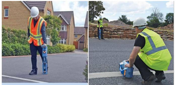
La protezione dinamica di sovraccarico rimuove l'interferenza e le consente di utilizzare in ambienti elettricamente rumorosi come sottostazioni e cavi di alimentazione aereo.  vantaggio Progettato per l'uso sul campo, ha una protezione per intrusione IP65 contro polvere e acqua.
