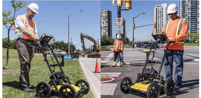
**LMX200™ è il principale dispositivo di posizione dell'utilità radar sotterranea (GPR) attualmente sul mercato.**
