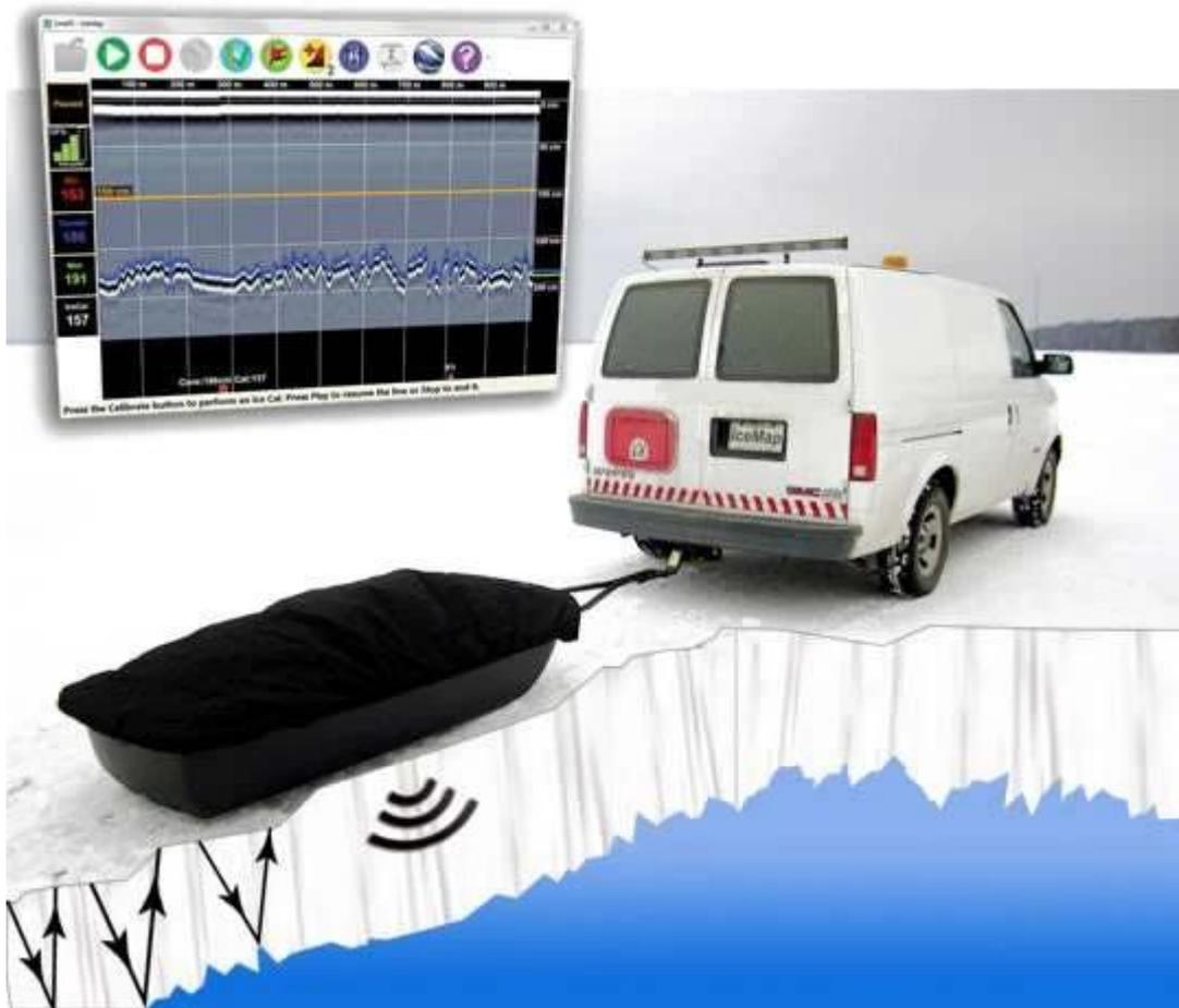
of [Radar sotterraneo](#) Il display Icemap <sup>TM</sup> in tempo reale visualizza la parte inferiore rilevata automaticamente del ghiaccio (linee blu) in tempo reale. Gli utenti possono impostare una soglia di avviso di spessore minimo (filo d'oro).
