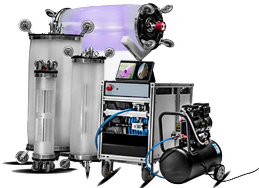
Il sistema di riparazione dei punti di controllo è costituito principalmente da due parti: il sistema di controllo principale e l'airbag. Le sue caratteristiche principali sono ad alta efficienza, stabilità, precisione e controllo, che consentono di riparare i siti di danno in 6 minuti.
