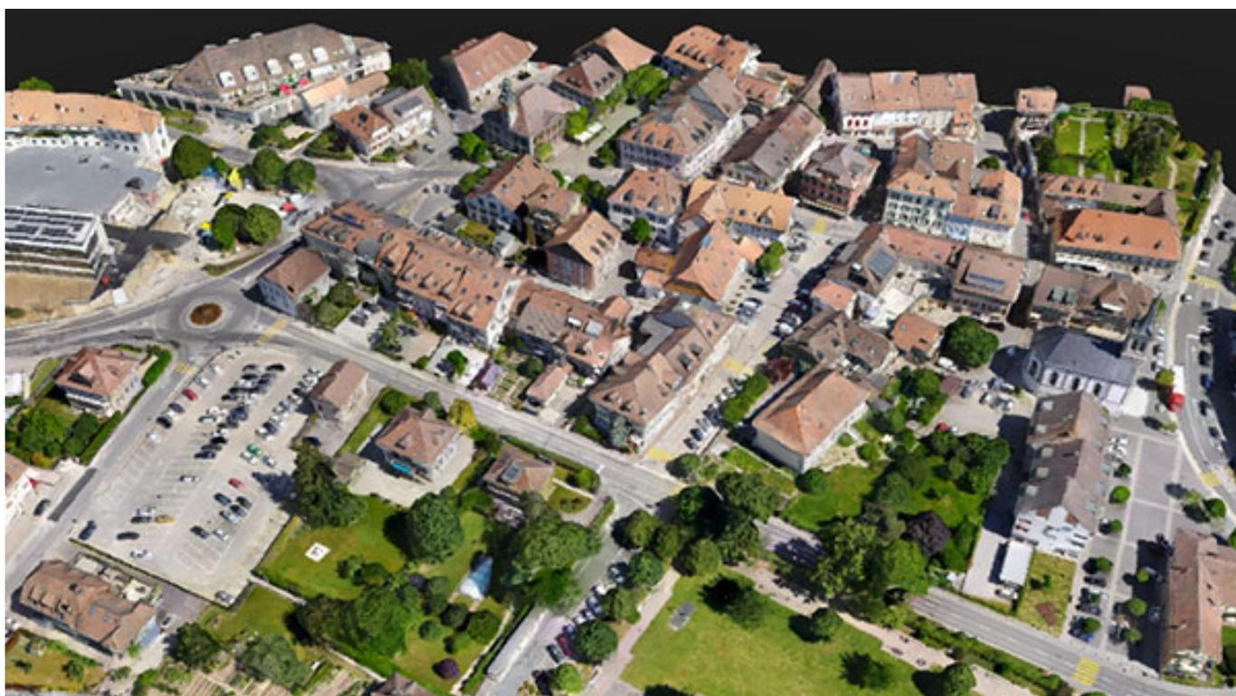
Genera una mesh testurizzata 3D definendo la dimensione della texture e i criteri di decimazione e visualizzala in modalità testurizzata o ombreggiata.
