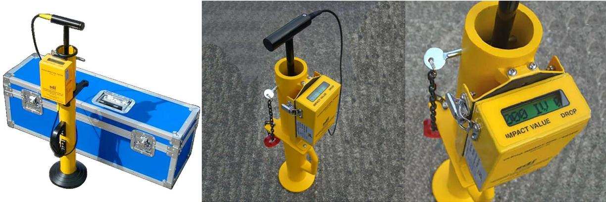
Il CIST / 883 Clegg da 4,5 kg è prodotto da SDI (SD InstrUmentation) e fornisce un metodo semplice e diretto per misurare e controllare la resistenza del suolo e i livelli di consolidamento durante il recupero del fosso. 883 Lo schermo di lettura è fissato al catetere e può essere visualizzato all'indirizzo la parte superiore durante l'uso. Design del funzionamento del programma a pulsante singolo, abbastanza facile da usare.
