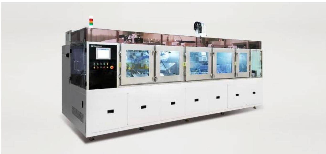
Le traitement entièrement automatique, du sablage au nettoyage et au séchage, peut être effectué avec une seule unité.
