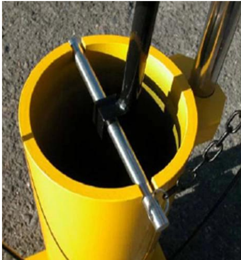
Marteau de 20 kg soutenu par une goupille de support pendant le transport
