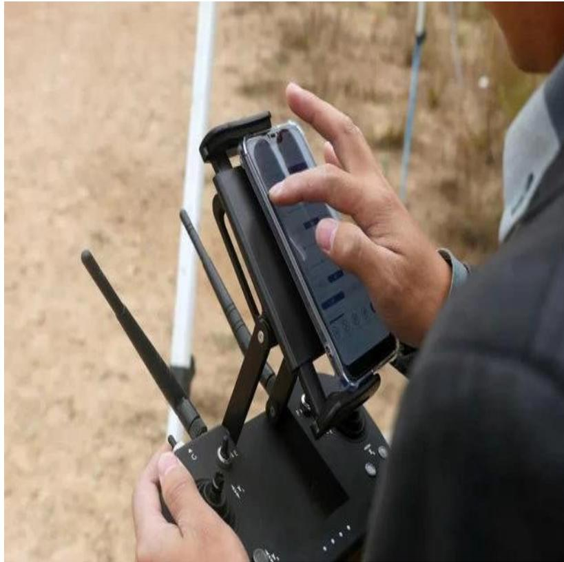
De plus, grâce au logiciel de la station au sol, les utilisateurs peuvent surveiller l'état du vol, mesurer les coordonnées en temps réel, définir les paramètres de vol et définir le point d'arrêt pour une pulvérisation continue. Dans le même temps, la station au sol PC dispose d'une diffusion vocale complète pour assurer la sécurité de l'opération.
