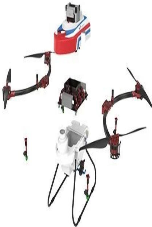
La machine complète M16 est principalement divisée en 7 modules: batterie d'alimentation, capot, cadre de fuselage, réservoir de liquide liquide, trépied, bras, buse, afin de faciliter le démontage et l'entretien quotidiens, la conception modulaire et le coût de maintenance sont faibles.
