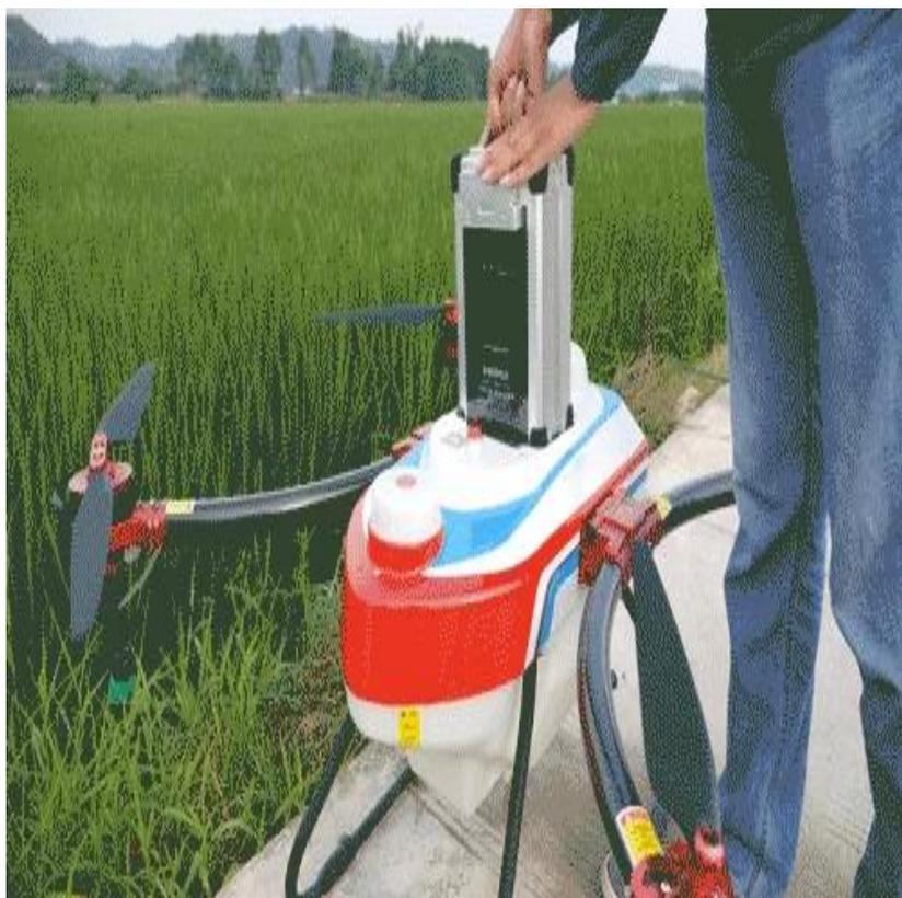
Le remplacement de la batterie est un problème pour de nombreux pilotes. La plupart des drones de protection des plantes sur le marché doivent d'abord installer la batterie sur l'avion, puis l'attacher avec une bande de fixation Velcro, puis connecter la prise. Cette voie est plus difficile et prend du temps.
