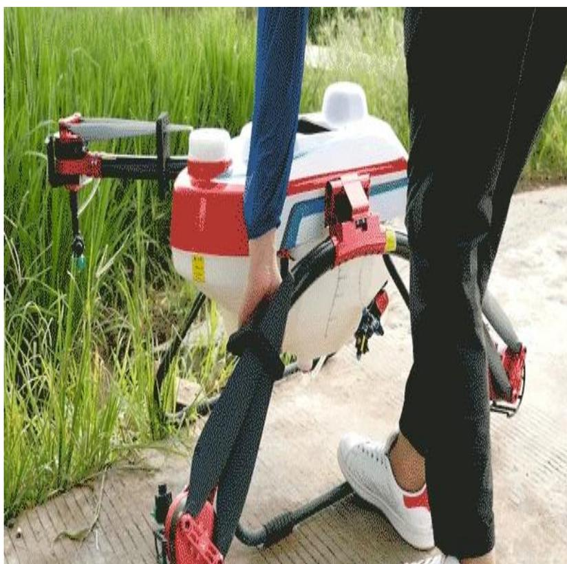
Le M16 adhère à la conception pratique du M12, bras pliant innovant de type C en un clic, utilisant un moulage intégré en matériau composite en fibre de carbone, une connexion sans soudure, un pliage pratique et augmente la résistance du bras, sa résistance est 1,5 fois supérieure à celle du carbone ordinaire fibre.
