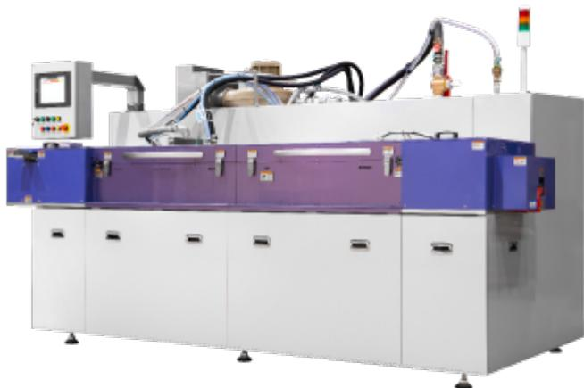
Équipement WLS pour le nettoyage et le décalaminage des billettes
