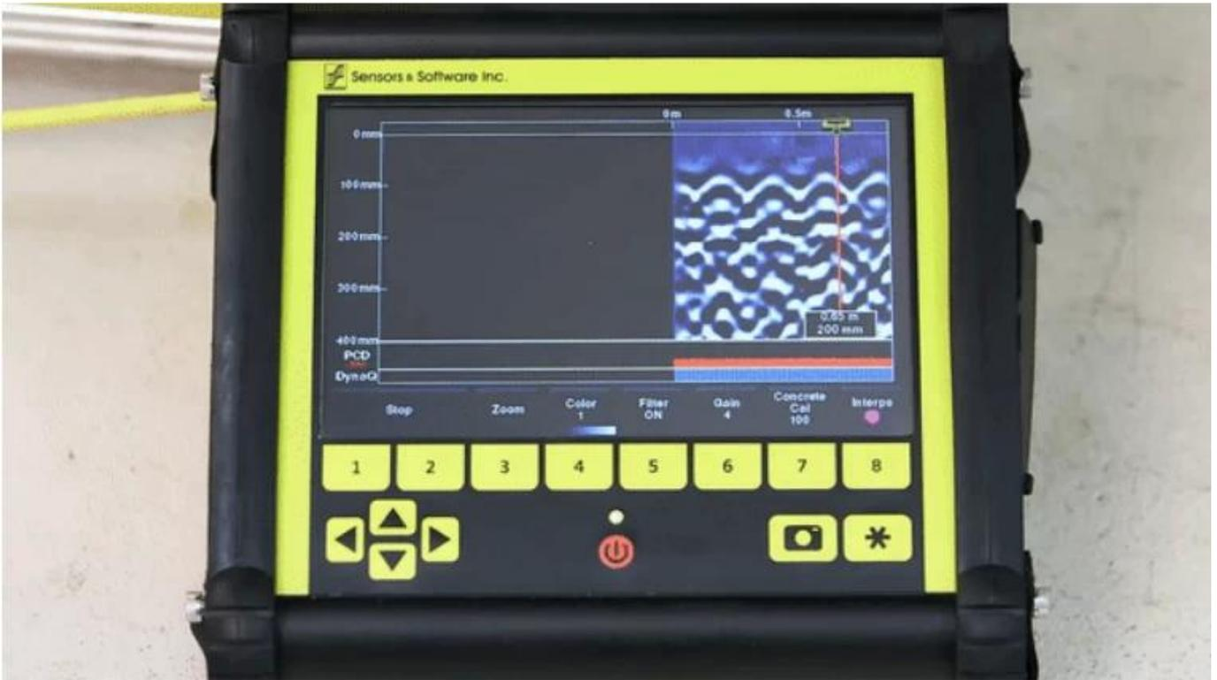
Positionnement au-delà des barres d'armature en béton
