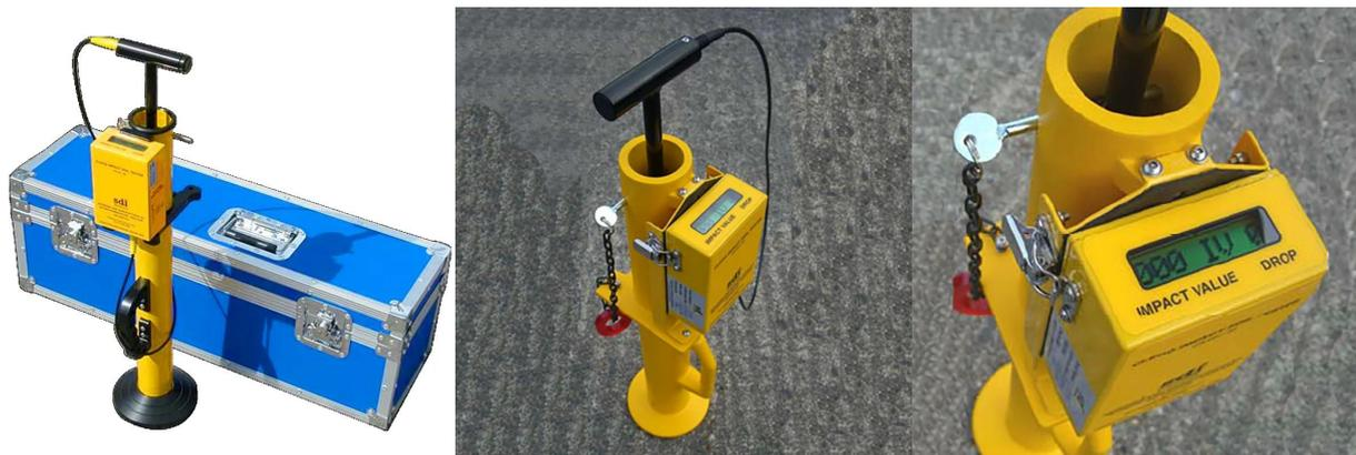
Le CIST / 883 Clegg de 4,5 kg est produit par SDI (SD Instrumentation) et fournit une méthode simple et directe de mesure et de contrôle de la résistance du sol et des niveaux de consolidation pendant la récupération du fossé. 883 L'écran de lecture est fixé au cathéter et peut être vu à le haut pendant l'utilisation. Conception de programme à bouton-poussoir unique, assez facile à utiliser.
