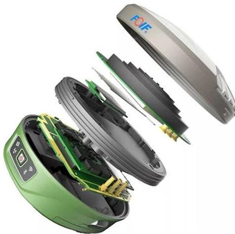
5. Estación de transceptor incorporada: Ajustable de 0.5 a 2W, Admite una variedad de protocolos de transmisión, La distancia de funcionamiento es de hasta 5 km.
