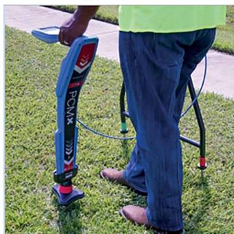
PCMX permite a los administradores de tuberías identificar y priorizar el mantenimiento preventivo de las tuberías. Prolonga la vida útil de sus activos identificando potencialmente la corrosión temprano.
