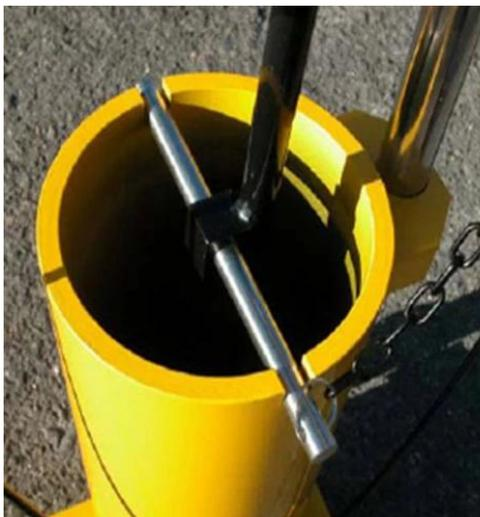
20-kg-Hammer, unterstützt durch Stützstift während des Transports
