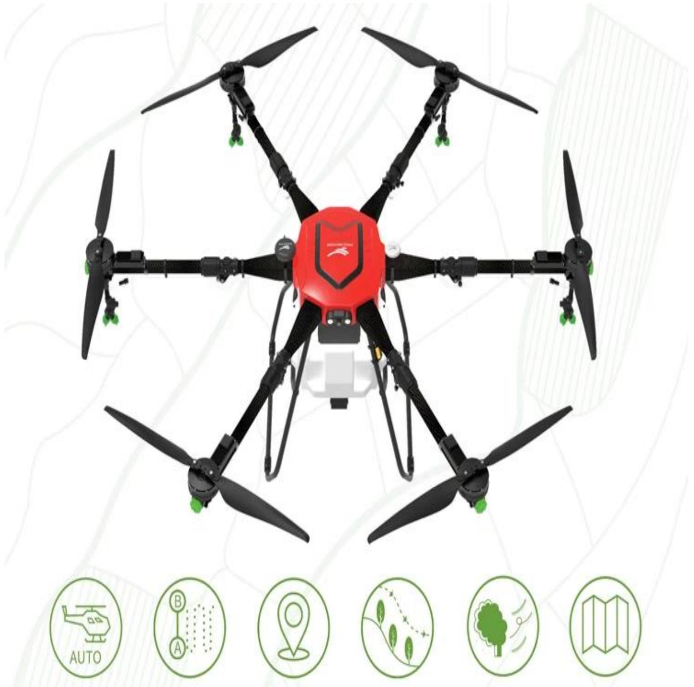
X25 ist eine elektrische sechssachsiges Pflanzenschutzmaschine mit einfachem Strukturdesign, hoher Betriebseffizienz, einfacher Steuerung und Funktionen wie Bodenflugimitation und autonomer Hindernisvermeidung. Seine Szene ist weit verbreitet und kann auf verschiedene Umgebungen und Gelände wie trockenes Land, Hügel, Berge usw. angewendet werden.
