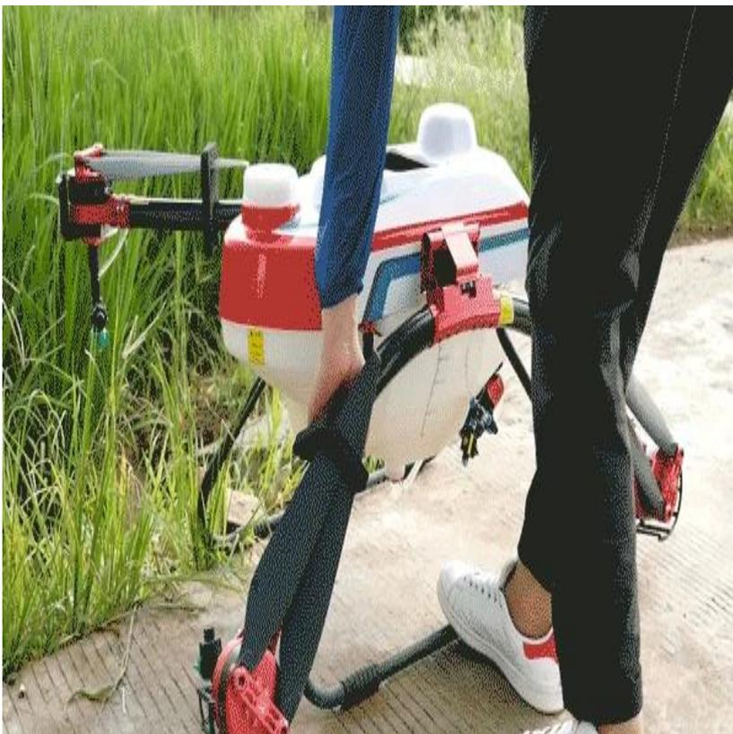
Der M16 folgt dem M12-Komfortdesign, dem innovativen C-Typ-Faltarm mit einem Klick, der integrierten Formung aus Kohlefaserverbundmaterial, der nahtlosen Verbindung, dem bequemen Zusammenklappen und der Erhöhung der Festigkeit des Arms. Seine Festigkeit beträgt das 1,5-fache der von gewöhnlichem
