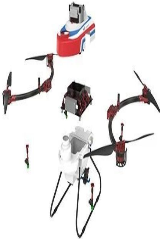
Die komplette M16-Maschine ist hauptsächlich in 7 Module unterteilt: Batterie, Motorhaube, Rumpfrahmen, Flüssigkeitstank, Stativ, Arm, Düse. Um die tägliche Demontage und Wartung zu erleichtern, sind der modulare Aufbau und die Wartungskosten niedrig.
