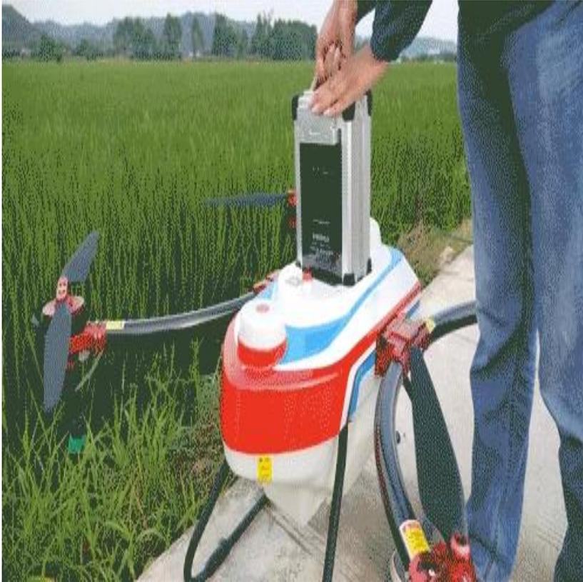
Der Batteriewechsel stellt für viele Piloten ein Problem dar. Bei den meisten Pflanzenschutzdrohnen auf dem Markt muss zuerst die Batterie im Flugzeug installiert, dann mit einem Klettband befestigt und dann der Stecker angeschlossen werden. Dieser Weg ist schwieriger und zeitaufwändiger.
