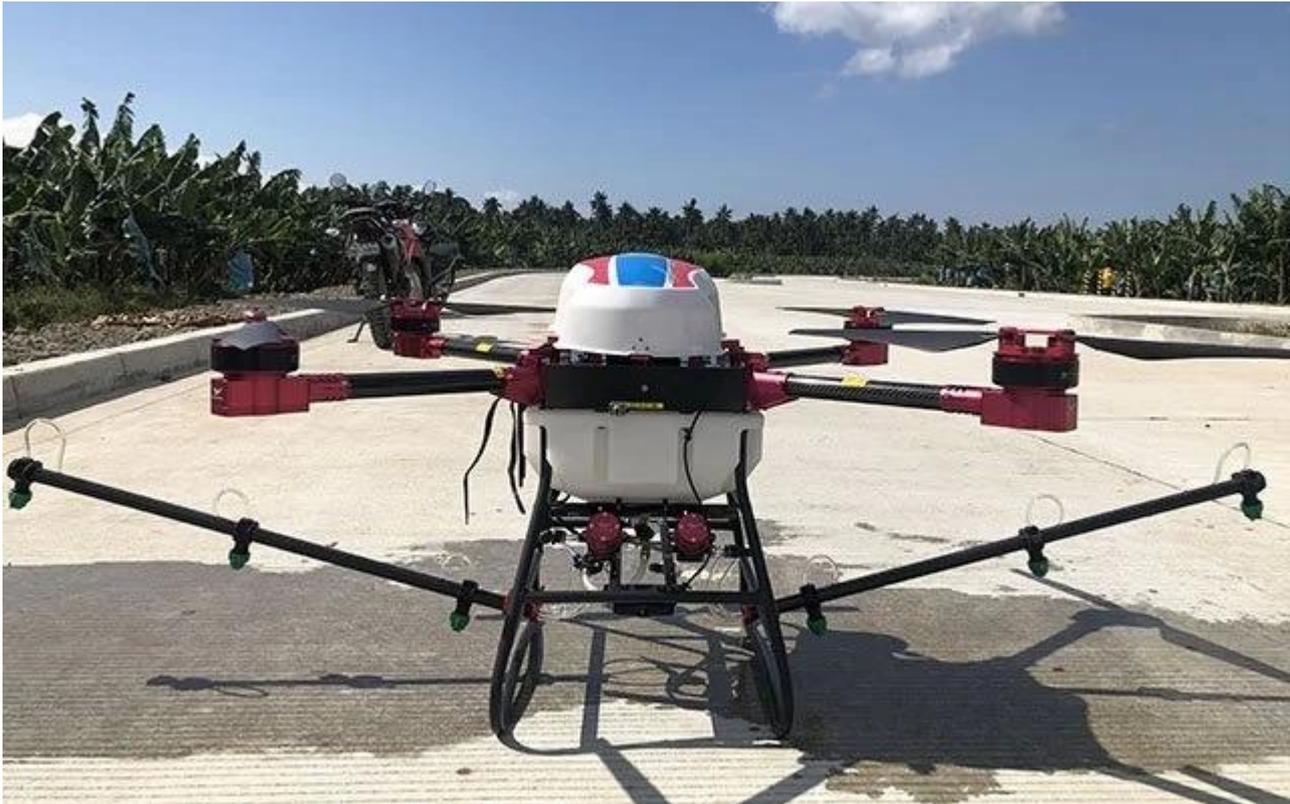
D10-Materialauswahl und -design, der Hauptkörper des Rumpfes besteht aus hochfestem Kohlefasermaterial, einfacher Struktur, weniger Gesamtverbindungsstelle, starker Sturzfestigkeit; Korrosionsmaterial für Medizinschränke, konkaves und konvexes Design, langlebig und verhindern das Schwingen von Flüssigkeiten, machen den Flug stabiler.
