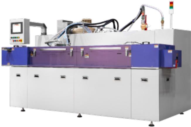
WLS-Anlage zum Reinigen und Entzundern von Knüppeln
