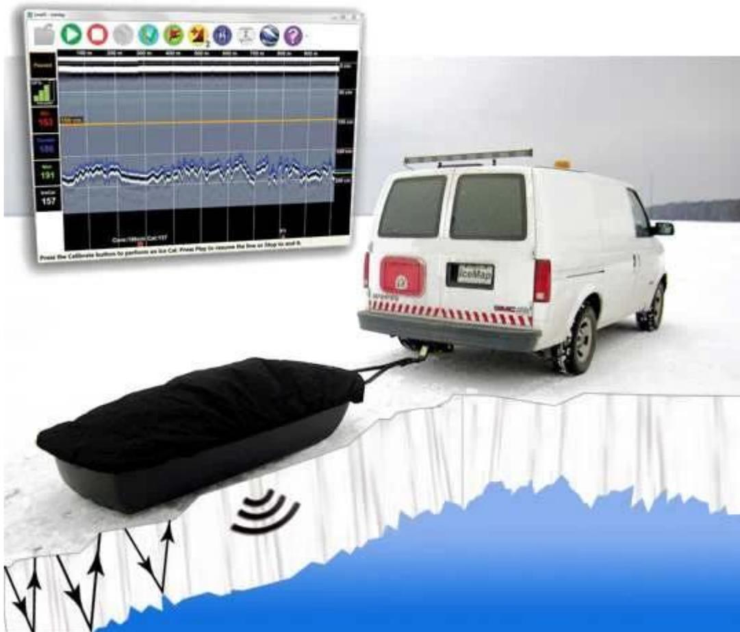
von [Unterirdischer Radar](#) Das Echtzeit-Display von IceMap™ zeigt den automatisch erkannten Boden von Eis (blaue Linien) in Echtzeit an. Benutzer können einen Warnschwellenwert der Mindestdicke (Golddraht) festlegen.
